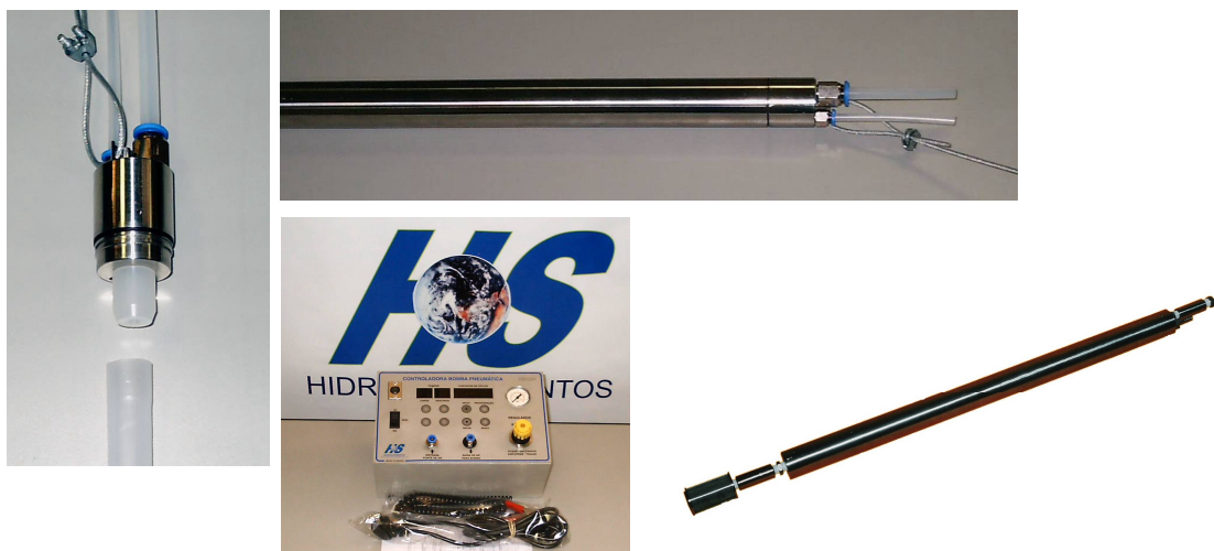
FIGURA 5.1.3.2 – BOMBAS SUBMERSAS PNEUMÁTICAS (BEXIGA)
