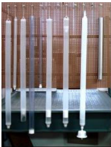
FIGURA 5.1.1.1 – AMOSTRADORES DESCARTÁVEIS E PERMANENTES (BAILERS)
